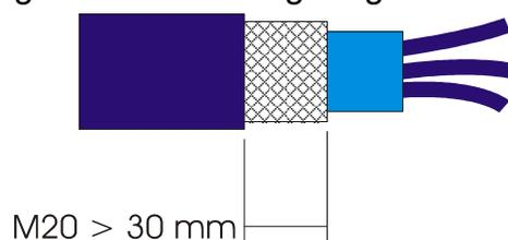
Der Metallschirm muss bei M20-Verschraubungen 30 mm lang sein. Fügen Sie das Kabel in die Verschraubung ein.
